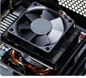
Görsel 2.16: Çalışırken ısınan bilgisayar işlemcisinden sıcak havayı uzaklaştıran fan
