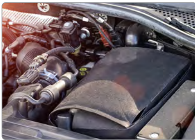
Görsel 4.22: Üstü ısı yalıtkanı kapakla örtülmüş motor
